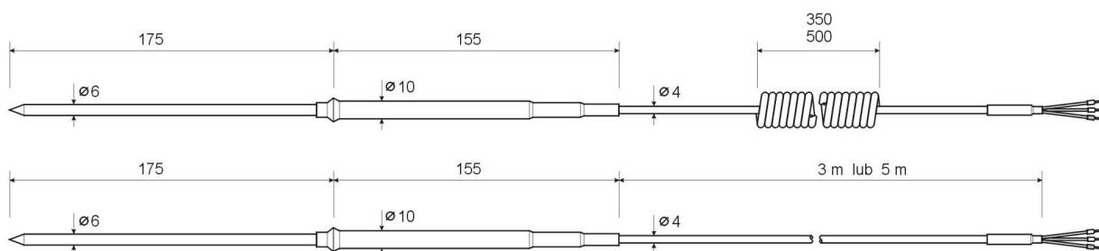
Rys. 1. Hermetyczny czujnik igłowy do chłodni Pt...- CDB z kablem prostym i spiralnym PUR.
